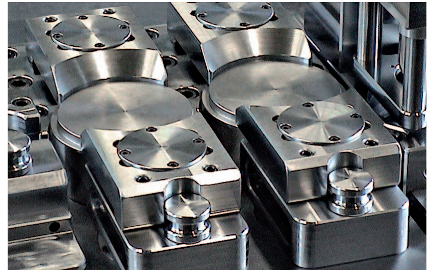
Doppelhydraulische Niederzugspannelemente in einem Rundgesenkhalterunterteil eines Fellner-Gesenkschnellwechselsystems für eine 6,5MN-Gesenkschmiede-Keilpresse mit gespannten Rundgesenkhalterunterteilattrappen [Ansicht von vorne-links-oben]
