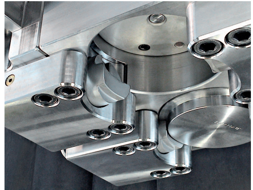
Hydromechanische Keilspannelemente in einem Rundgesenkhalteroberteil eines Fellner-Gesenkschnellwechselsystems für eine 6,5MN-Gesenkschmiede-Keilpresse (Ansicht von hinten-rechts-unten)
