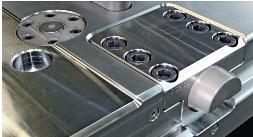
Hydromechanisches Keilspannelement in einem Grundhalterunterteil eines Fellner-Gesenkhalter-Kassettschnellwechselsystems für eine 16MN-Gesenkschmiede-Exzenterpresse
