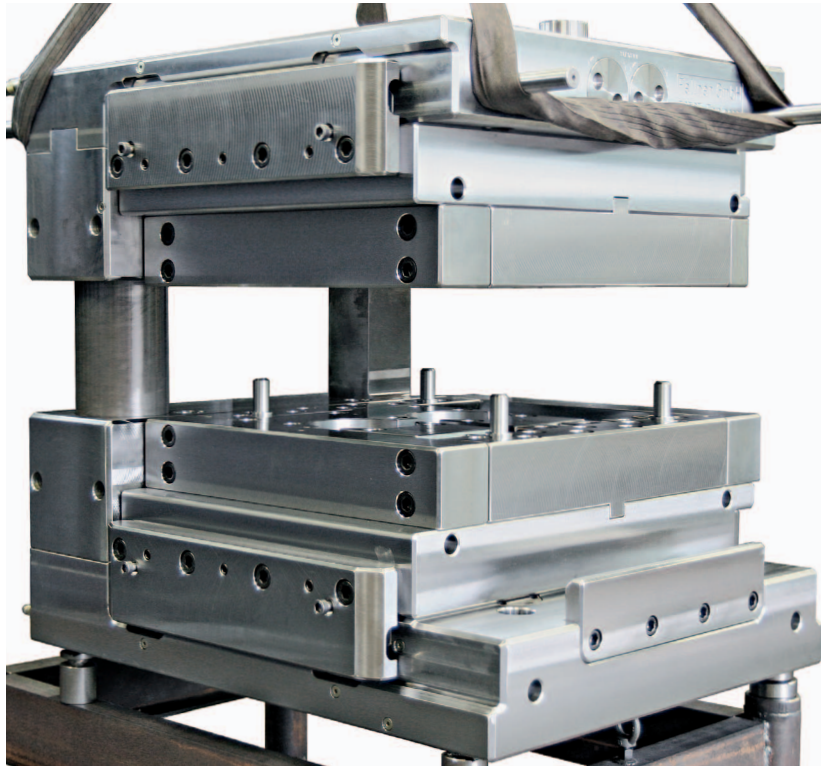
Grundhalter mit eingebauter, gespannter Rechteck- / Rundgesenkkassette auf Pressentischtrappe, Grundhalteroberenteil in Position: „Pressenstößel oben“ (Ansicht von vorne-links)
