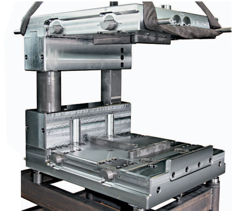
Grundhalter mit Flach-Rund-Säulenführung, festen Zentrierleisten im Grundhalterunter- und verstellbaren Zentrierleisten im Grundhalteroberteil, doppelhydraulischen Kassetten-Anhebezyllindern im Grundhalterunterteil sowie hydromechanischen Kassettenkeilspannelementen in Grundhalterunter- und -oberteil (Ansicht von vorne-links)
