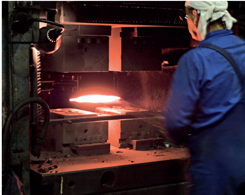
Im Schmiedeeinsatz: Gesenkhalter-Kassettschnellwechselsystem 08-25 mit 3-Stationen-Rechteckgesenkkassette, hier mit 2 Schmiedestationen zentrisch bestückt
