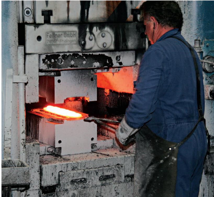
Im Schmiedeeinsatz: Gesenkhalter-Kassettenschnellwechselsystem 08-10 mit 2-Stationen-Schwalbenschwanzgesenkkassette, hier mit einer Schmiedestation bestückt
