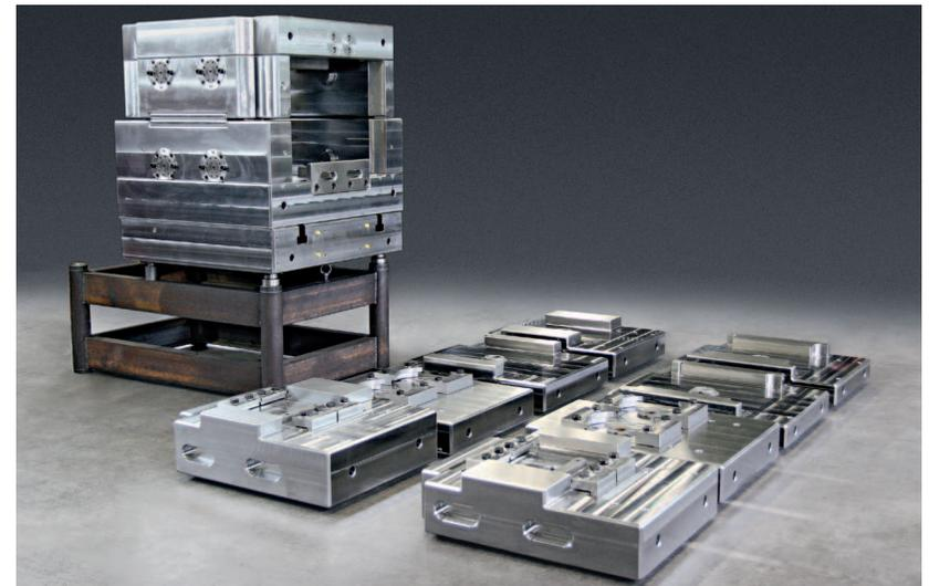
Grundhalter auf Zwischenplatte und Pressentischatruppe, Grundhalteroberteil in Position: „Pressenstößel unten“, davor jeweils eine aufgeklappte, einbaubereite, komplette Rechteck- und Rundgesenkkassette sowie zwei Schwalbenschwanzgesenkkassetten (von links nach rechts) (Ansicht von vorne-links)
