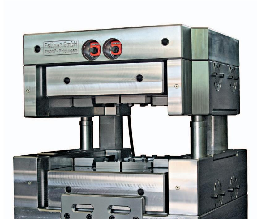
Grundhalter mit Flach-Rund-Säulenführung, mechanisch-digitalen Positionsanzeigen des Schmiedeversatzkorrektursystems sowie eingebauter Rechteckgesenkkassette, Grundhalteroberenteil in Position: „Pressenstößel ¾ oben“ (Ansicht von vorne-rechts)
