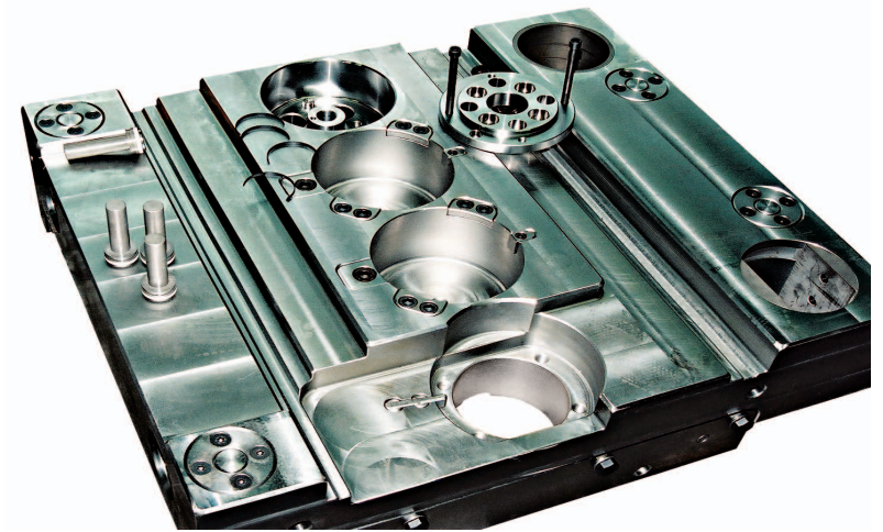
4-Stationen-Rundgesenkkassettenoberteil mit Führungsplatten, -buchse sowie ausgebauten Hochtemperatur-Stickstoffedern der Loch-Abgrat-Kombistation (Ansicht von vorne-links-unten)
