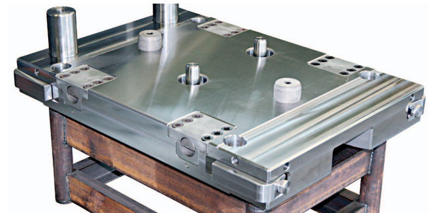
Grundhalterunterteil mit hydromechanischen Kassettenkeilspannelementen in verstärkter Ausführung (hier: Spannkolben eingefahren), Auswerferbolzen, Kassettencentrierungen und -anschlägen: übersichtlich, unempfindlich und leicht zu reinigen für einen sehr schnellen, einfachen Kassettenwechsel (Ansicht von vorne-links-oben)
