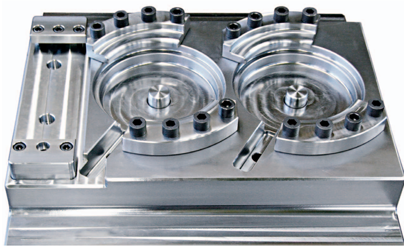
Rundgesenkkassettenunterteil mit 3 Schmiedestationen, von links nach rechts: Vorstauchen, Vorschmieden, Fertigschmieden (Ansicht von vorne-oben)
