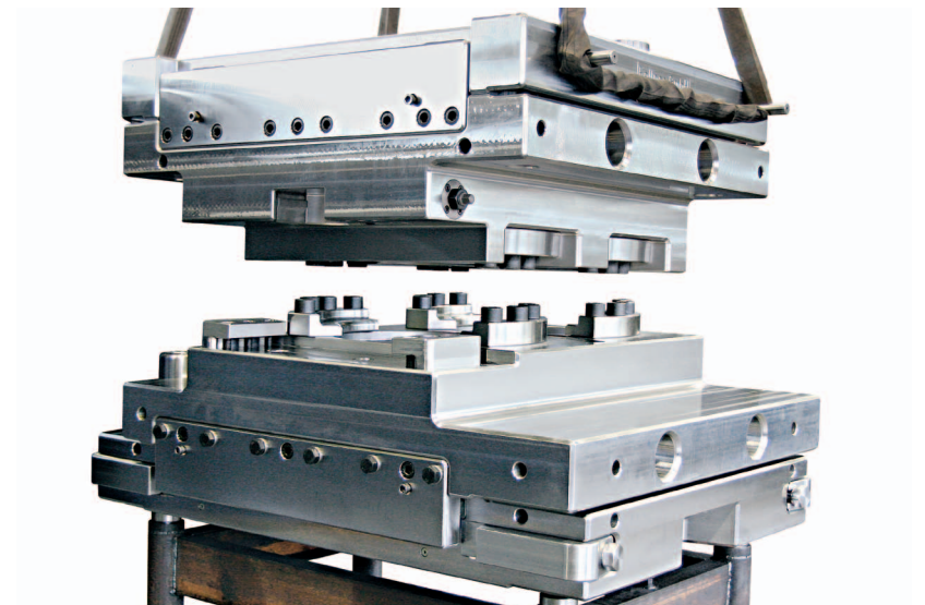
Grundhalter mit eingebauter, gespannter Rundgesenkkasette, Grundhalteroberteil in Position: „Pressenstößel unten“ (Ansicht von vorne-links)
