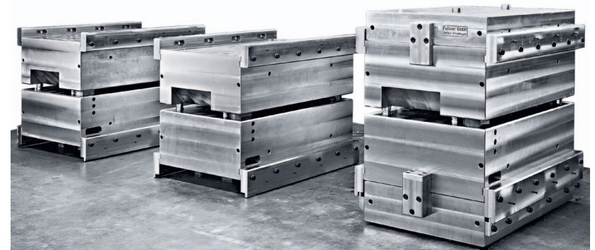
Grundhalter mit eingebauter, gespannter Rechteckgesenkkassette, Grundhalteroberteil in Position: „Pressenstößel unten“, links daneben einbaubereite, komplette Rechteckgesenkkassetten (Ansicht von vorne-rechts)
